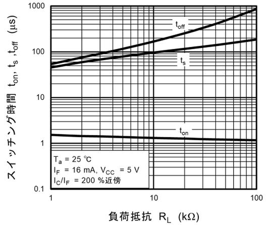
図 12.14 スイッチング時間 -  $R_L$
