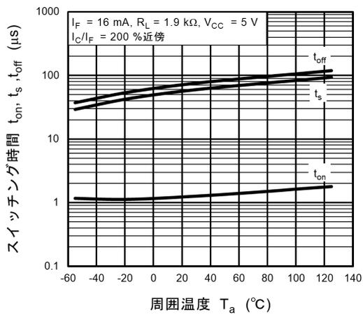
図 12.15 スイッチング時間 -  $T_a$
