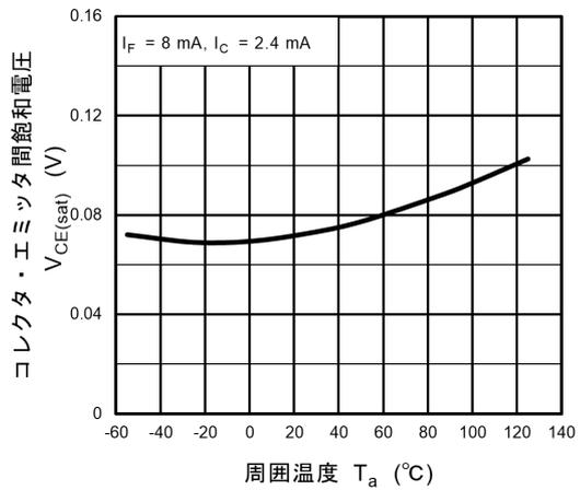
図 12.10  $V_{CE(sat)} - T_a$
