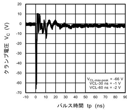
図 11.2.6 ISO10605 クランプ波形 -8 kV
