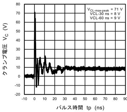
図 11.4.5 ISO10605 クランプ波形 +8 kV
