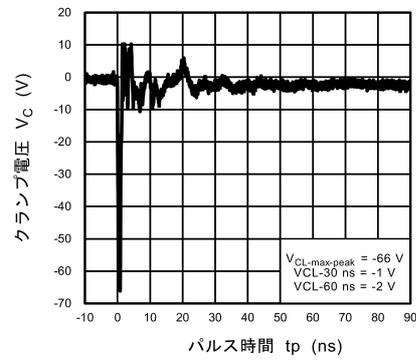
図 11.3.6 ISO10605 クランプ波形 -8 kV
