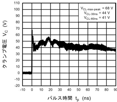
図 11.19.3 IEC61000-4-2 クランプ波形 +8 kV
