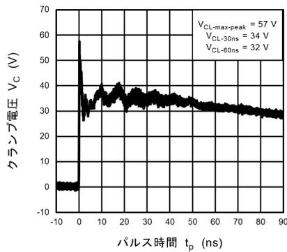
図 11.17.3 IEC61000-4-2 クランプ波形 +8 kV
