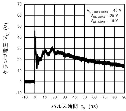
図 11.9.3 IEC61000-4-2 クランプ波形 +8 kV
