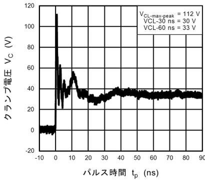
図 11.18.5 ISO10605 クランプ波形 +8 kV
