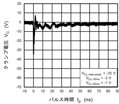
図 11.2.4 IEC61000-4-2 クランプ波形 -8 kV
