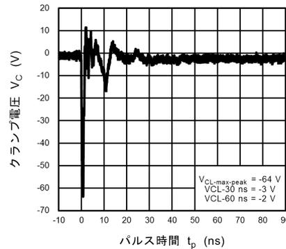
図 11.16.6 ISO10605 クランプ波形 -8 kV
