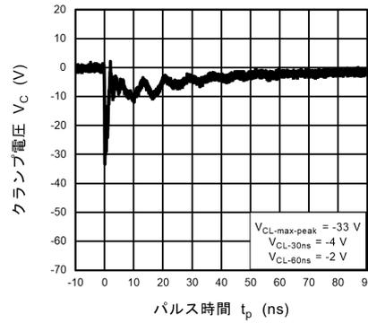
図 11.18.4 IEC61000-4-2 クランプ波形 -8 kV
