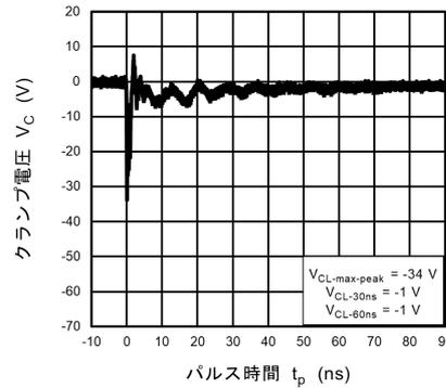
図 11.14.4 IEC61000-4-2 クランプ波形 -8 kV
