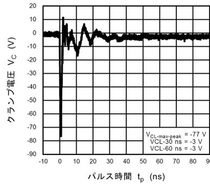
図 11.18.6 ISO10605 クランプ波形 -8 kV
