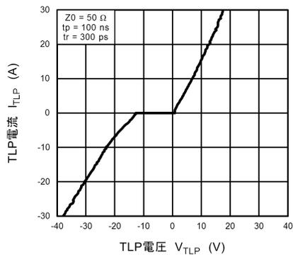
図 11.11.1  $I_{TLP} - V_{TLP}$
