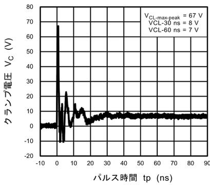
図 11.2.5 ISO10605 クランプ波形 +8 kV
