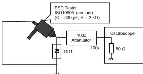
図 11.22.3 クランプ波形測定回路
