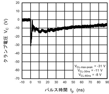
図 11.7.4 IEC61000-4-2 クランプ波形 -8 kV
