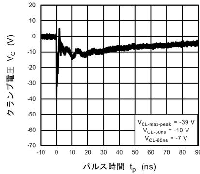
図 11.8.4 IEC61000-4-2 クランプ波形 -8 kV
