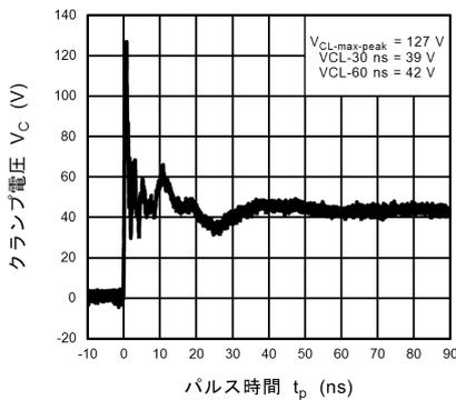
図 11.20.5 ISO10605 クランプ波形 +8 kV
