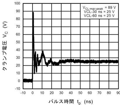
図 11.16.5 ISO10605 クランプ波形 +8 kV
