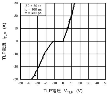
図 11.10.1  $I_{TLP} - V_{TLP}$
