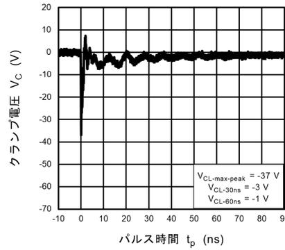
図 11.12.4 IEC61000-4-2 クランプ波形 -8 kV
