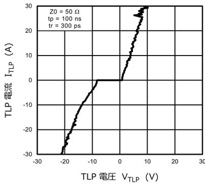
図 11.6.1  $I_{TLP} - V_{TLP}$
