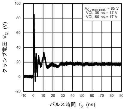
図 11.12.5 ISO10605 クランプ波形 +8 kV
