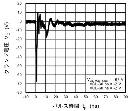
図 11.7.6 ISO10605 クランプ波形 -8 kV
