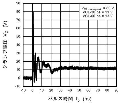
図 11.7.5 ISO10605 クランプ波形 +8 kV
