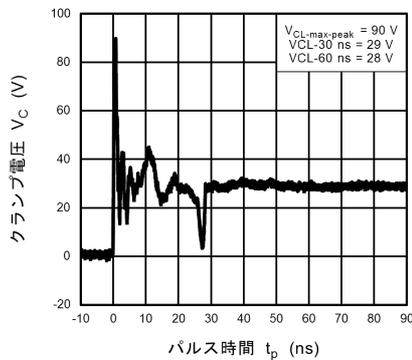
図 11.17.5 ISO10605 クランプ波形 +8 kV
