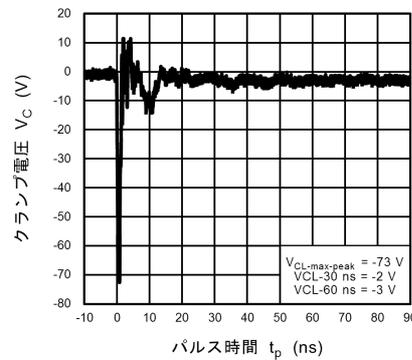
図 11.17.6 ISO10605 クランプ波形 -8 kV
