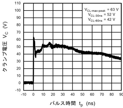
図 11.18.3 IEC61000-4-2 クランプ波形 +8 kV
