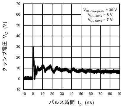
図 11.2.3 IEC61000-4-2 クランプ波形 +8 kV
