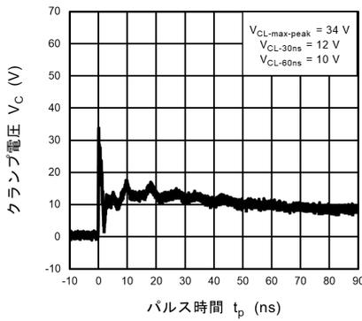
図 11.4.3 IEC61000-4-2 クランプ波形 +8 kV
