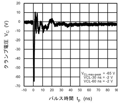
図 11.8.6 ISO10605 クランプ波形 -8 kV
