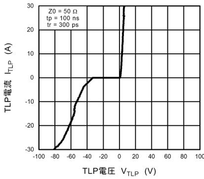
図 11.20.1  $I_{TLP} - V_{TLP}$
