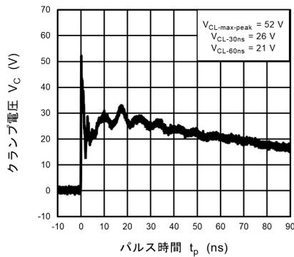
図 11.15.3 IEC61000-4-2 クランプ波形 +8 kV
