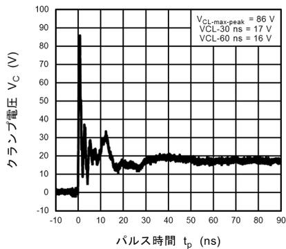
図 11.11.5 ISO10605 クランプ波形 +8 kV
