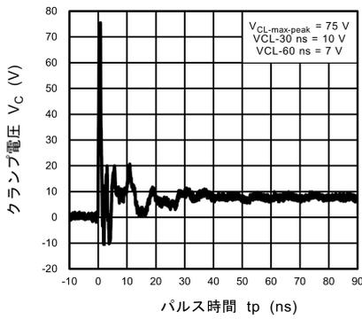
図 11.3.5 ISO10605 クランプ波形 +8 kV
