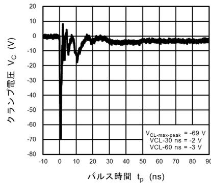
図 11.9.6 ISO10605 クランプ波形 -8 kV
