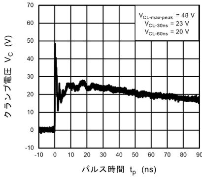
図 11.12.3 IEC61000-4-2 クランプ波形 +8 kV
