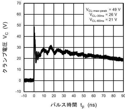
図 11.13.3 IEC61000-4-2 クランプ波形 +8 kV
