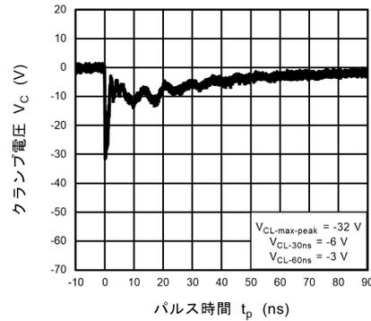
図 11.19.4 IEC61000-4-2 クランプ波形 -8 kV
