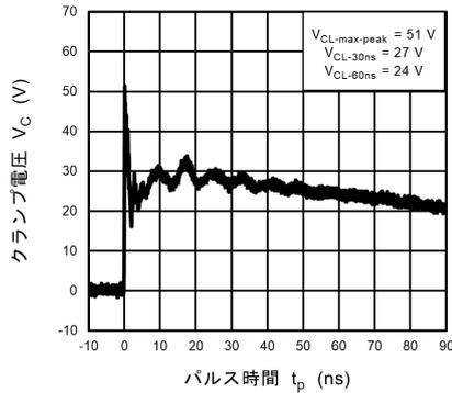
図 11.14.3 IEC61000-4-2 クランプ波形 +8 kV
