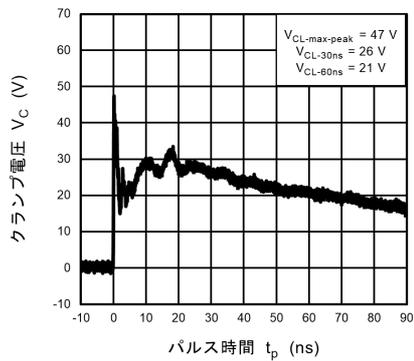
図 11.11.3 IEC61000-4-2 クランプ波形 +8 kV
