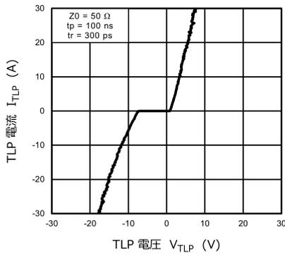
図 11.5.1  $I_{TLP} - V_{TLP}$
