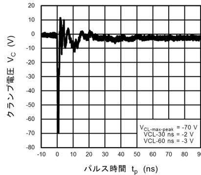
図 11.13.6 ISO10605 クランプ波形 -8 kV
