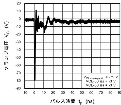
図 11.19.6 ISO10605 クランプ波形 -8 kV
