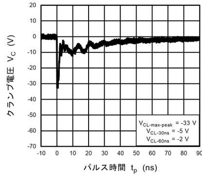
図 11.21.4 IEC61000-4-2 クランプ波形 -8 kV
