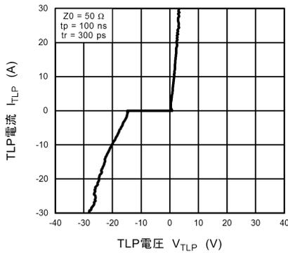
図 11.12.1  $I_{TLP} - V_{TLP}$
