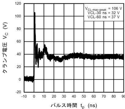
図 11.19.5 ISO10605 クランプ波形 +8 kV
