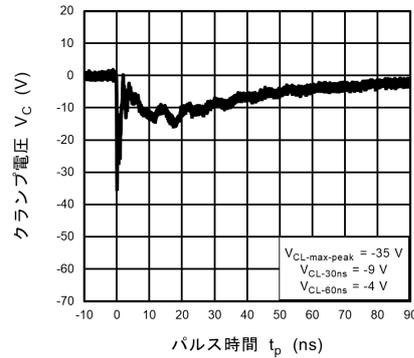
図 11.10.4 IEC61000-4-2 クランプ波形 -8 kV
