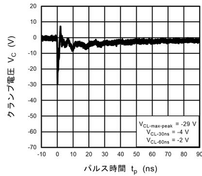
図 11.3.4 IEC61000-4-2 クランプ波形 -8 kV
