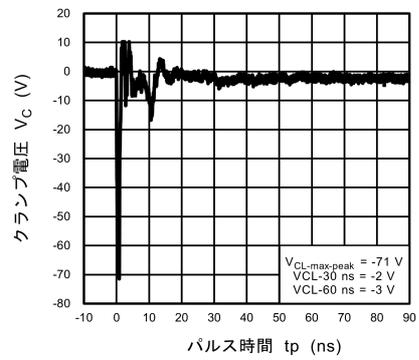
図 11.4.6 ISO10605 クランプ波形 -8 kV
