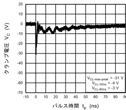
図 11.17.4 IEC61000-4-2 クランプ波形 -8 kV
