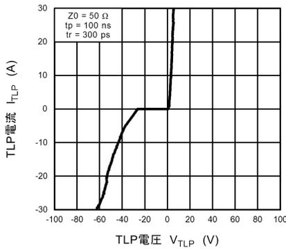
図 11.18.1  $I_{TLP} - V_{TLP}$
