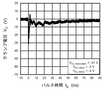
図 11.4.4 IEC61000-4-2 クランプ波形 -8 kV
