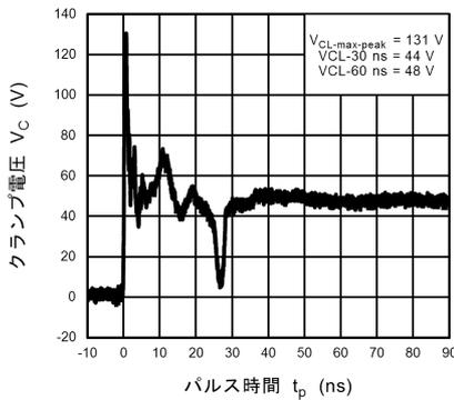
図 11.21.5 ISO10605 クランプ波形 +8 kV
