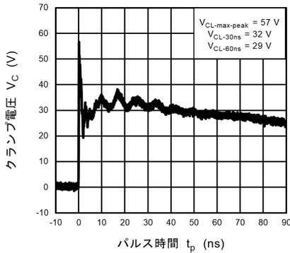
図 11.16.3 IEC61000-4-2 クランプ波形 +8 kV
