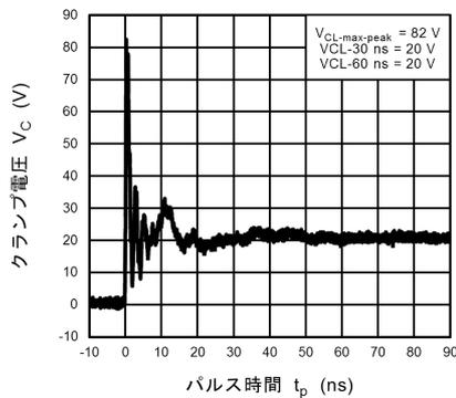
図 11.14.5 ISO10605 クランプ波形 +8 kV
