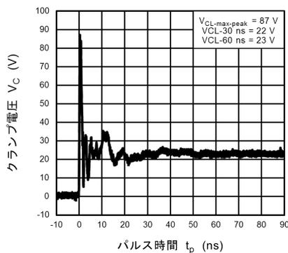
図 11.15.5 ISO10605 クランプ波形 +8 kV
