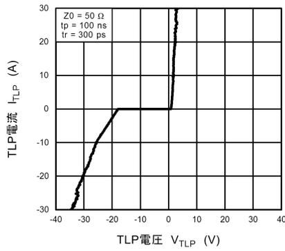
図 11.14.1  $I_{TLP} - V_{TLP}$
