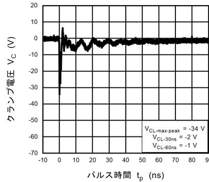
図 11.16.4 IEC61000-4-2 クランプ波形 -8 kV
