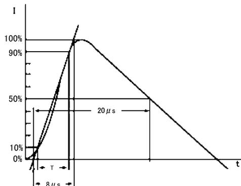
図 11.22.1  $V_C$ -I<sub>PP</sub> 印加波形
