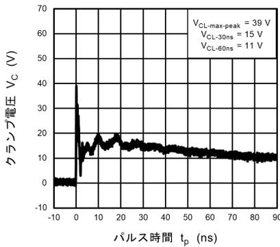
図 11.6.3 IEC61000-4-2 クランプ波形 +8 kV
