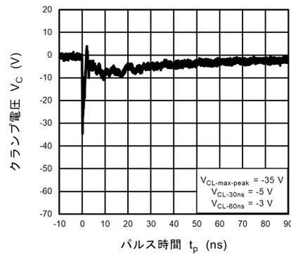
図 11.15.4 IEC61000-4-2 クランプ波形 -8 kV
