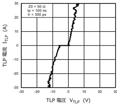
図 11.3.1  $I_{TLP} - V_{TLP}$
