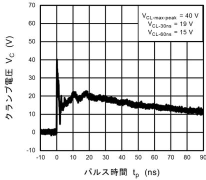
図 11.7.3 IEC61000-4-2 クランプ波形 +8 kV
