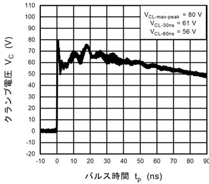
図 11.21.3 IEC61000-4-2 クランプ波形 +8 kV
