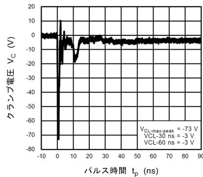
図 11.11.6 ISO10605 クランプ波形 -8 kV
