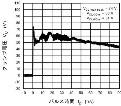
図 11.20.3 IEC61000-4-2 クランプ波形 +8 kV
