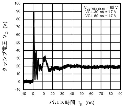
図 11.13.5 ISO10605 クランプ波形 +8 kV
