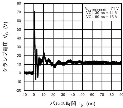
図 11.8.5 ISO10605 クランプ波形 +8 kV
