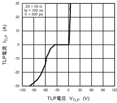
図 11.21.1  $I_{TLP} - V_{TLP}$
