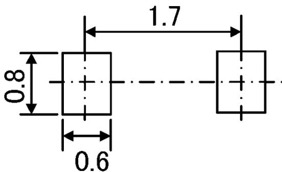
図 10.1 参考パッド寸法(Unit: mm)
