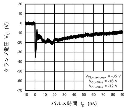
図 11.9.4 IEC61000-4-2 クランプ波形 -8 kV
