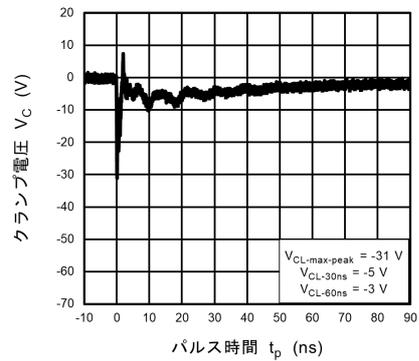
図 11.6.4 IEC61000-4-2 クランプ波形 -8 kV
