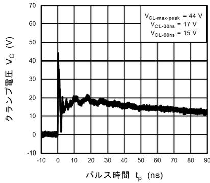
図 11.8.3 IEC61000-4-2 クランプ波形 +8 kV
