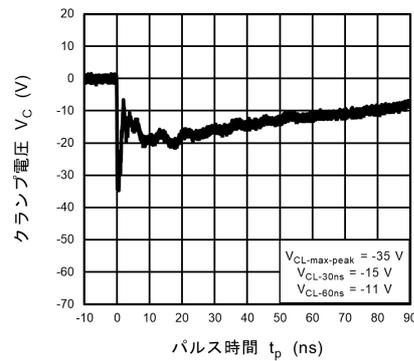
図 11.11.4 IEC61000-4-2 クランプ波形 -8 kV
