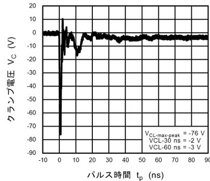
図 11.10.6 ISO10605 クランプ波形 -8 kV
