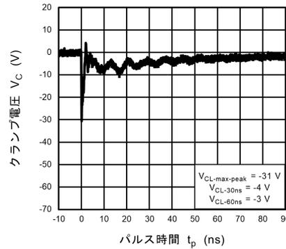
図 11.13.4 IEC61000-4-2 クランプ波形 -8 kV
