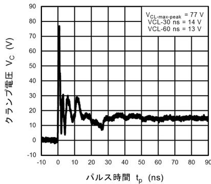
図 11.9.5 ISO10605 クランプ波形 +8 kV
