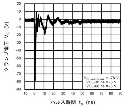
図 11.21.6 ISO10605 クランプ波形 -8 kV
