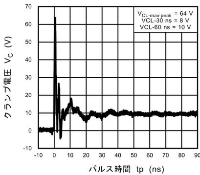
図 11.5.5 ISO10605 クランプ波形 +8 kV
