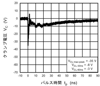
図 11.5.4 IEC61000-4-2 クランプ波形 -8 kV
