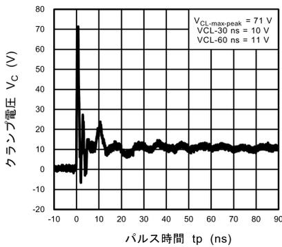
図 11.6.5 ISO10605 クランプ波形 +8 kV
