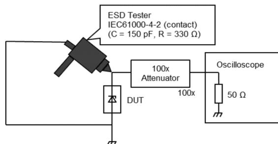
図 11.22.2 クランプ波形測定回路
