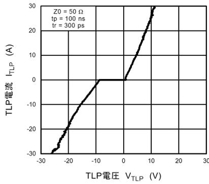
図 11.7.1  $I_{TLP} - V_{TLP}$
