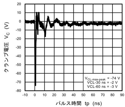
図 11.6.6 ISO10605 クランプ波形 -8 kV
