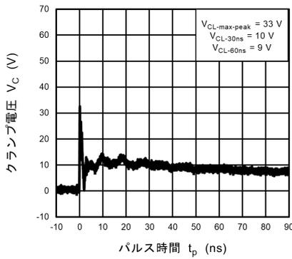
図 11.3.3 IEC61000-4-2 クランプ波形 +8 kV
