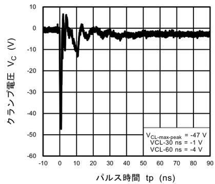
図 11.5.6 ISO10605 クランプ波形 -8 kV
