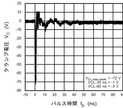
図 11.12.6 ISO10605 クランプ波形 -8 kV
