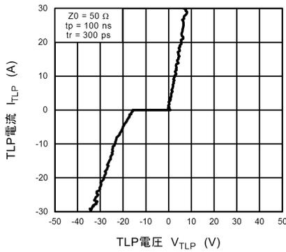
図 11.13.1  $I_{TLP} - V_{TLP}$
