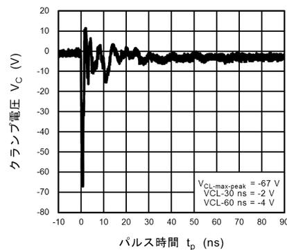
図 11.15.6 ISO10605 クランプ波形 -8 kV
