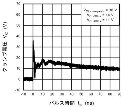
図 11.5.3 IEC61000-4-2 クランプ波形 +8 kV
