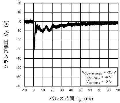
図 11.20.4 IEC61000-4-2 クランプ波形 -8 kV
