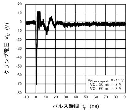
図 11.14.6 ISO10605 クランプ波形 -8 kV
