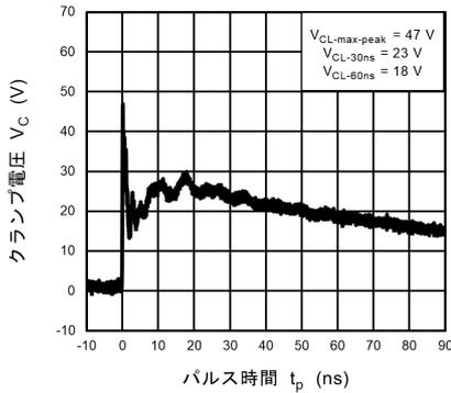
図 11.10.3 IEC61000-4-2 クランプ波形 +8 kV
