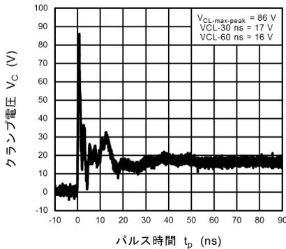
図 11.10.5 ISO10605 クランプ波形 +8 kV
