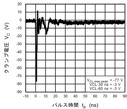
図 11.20.6 ISO10605 クランプ波形 -8 kV
