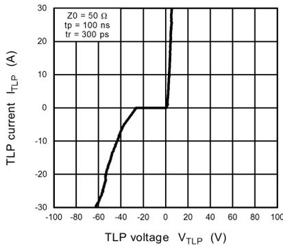
**Fig. 11.18.1**  $I_{TLP} - V_{TLP}$
