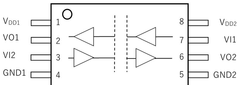
図 6.1 端子配置図 (top view)
