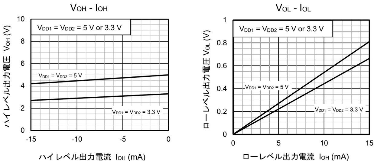
図 12.2 出力電圧 - 出力電流
