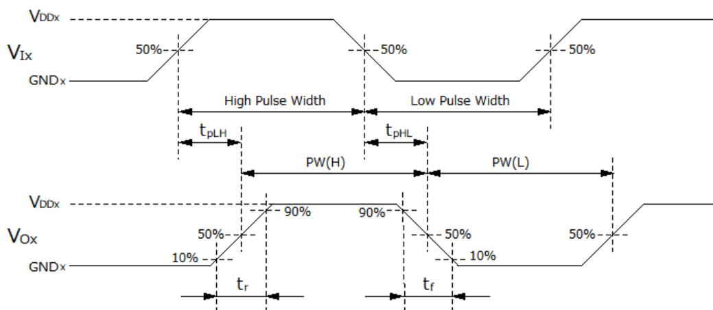
図 12.4 スイッチング波形特性図
