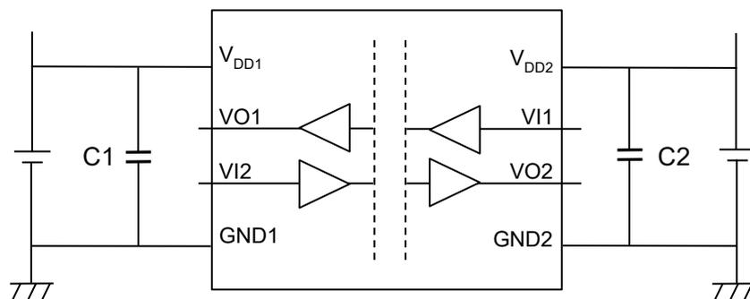
図 8.1 外付け部品回路図 (top view)
