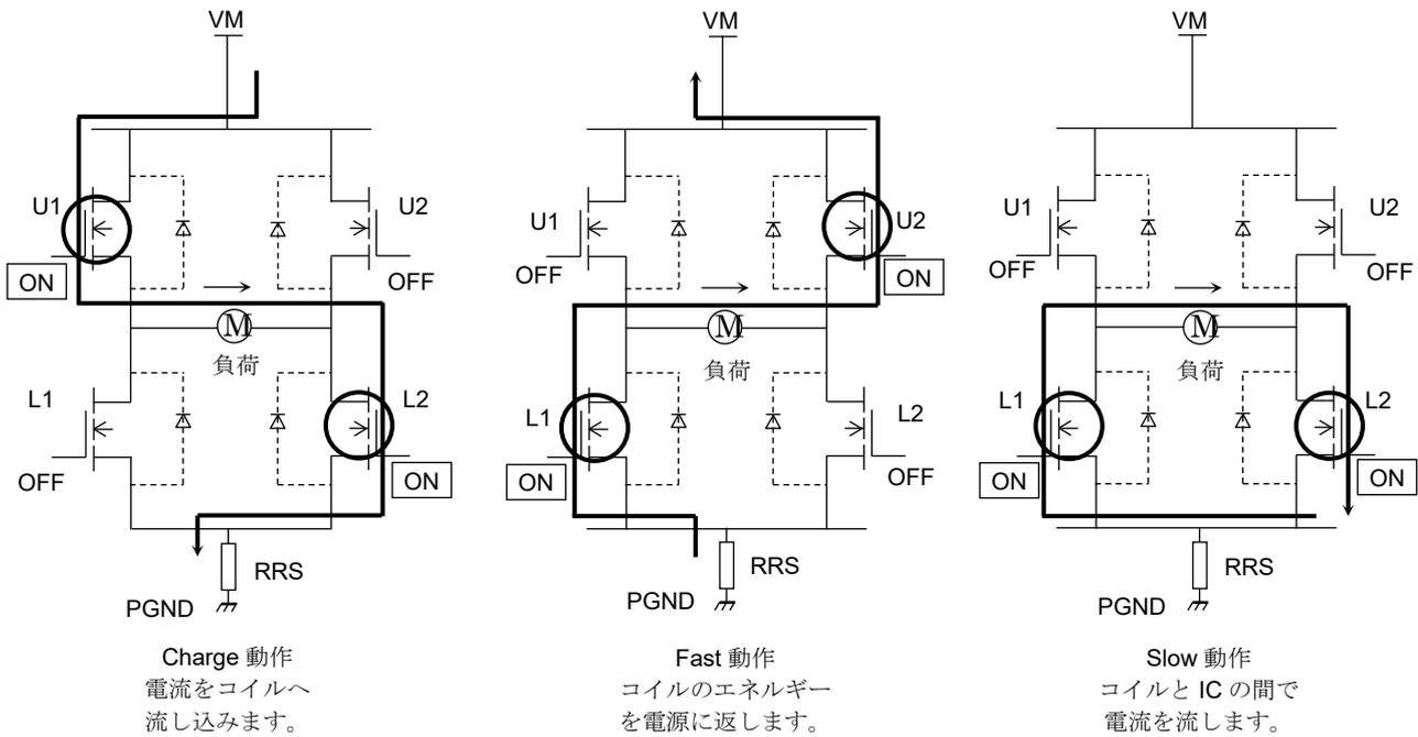
図 9.1 出力トランジスタ動作モード(正転)
