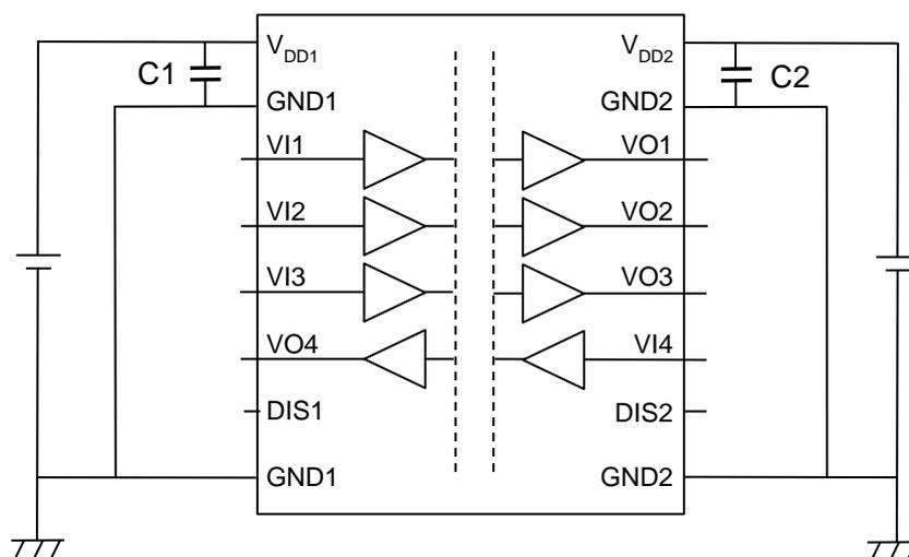
図 8.1 外付け部品回路図 (top view)
