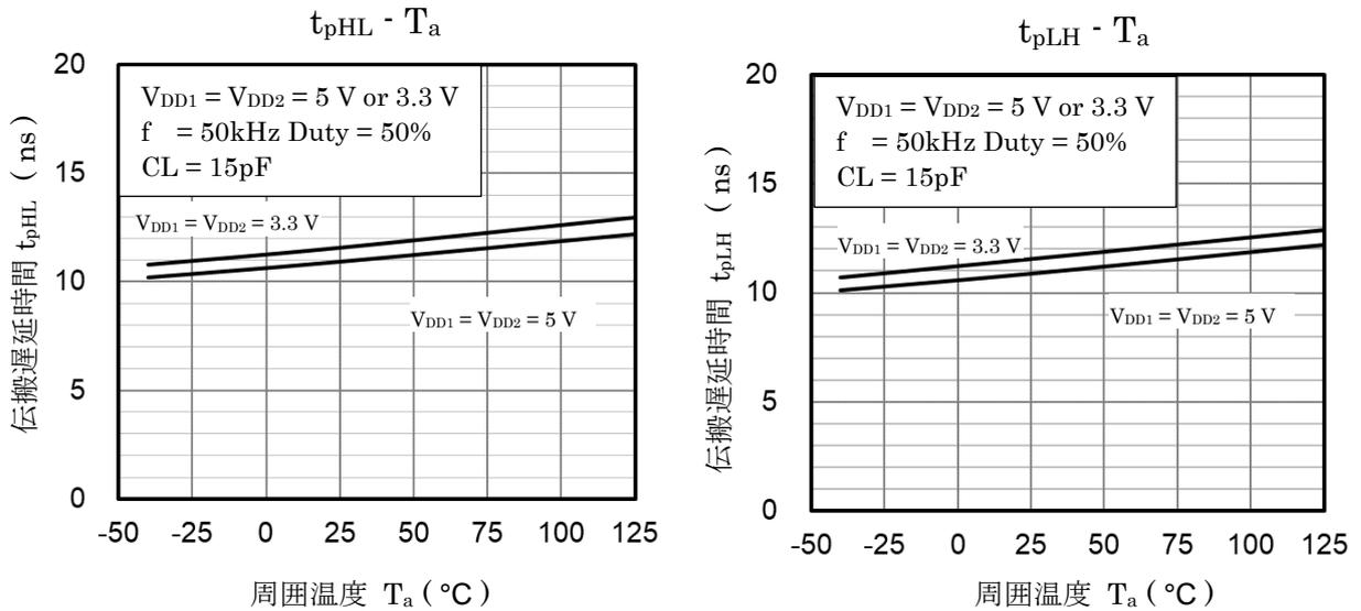
図 12.3 伝搬遅延時間 - 周囲温度
