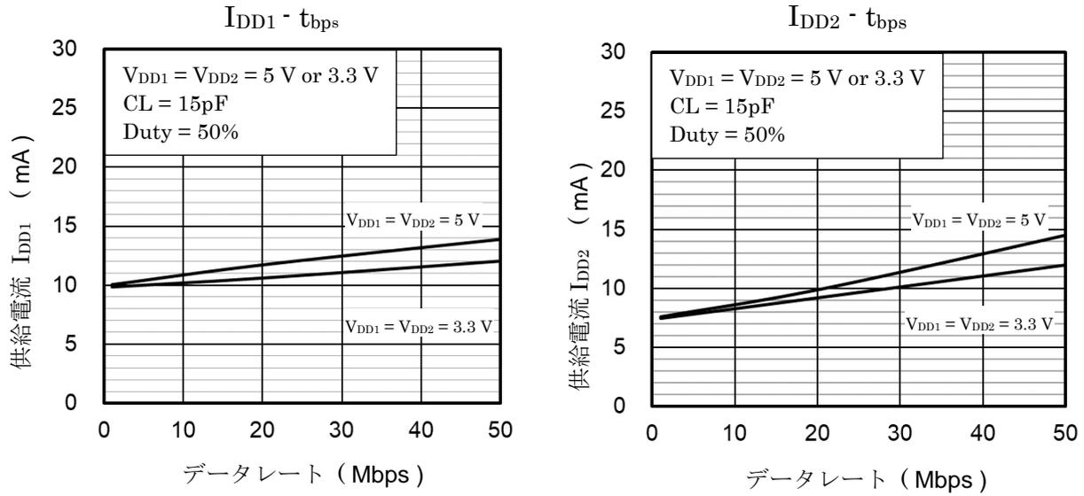
図 12.1 供給電流 - データレート
