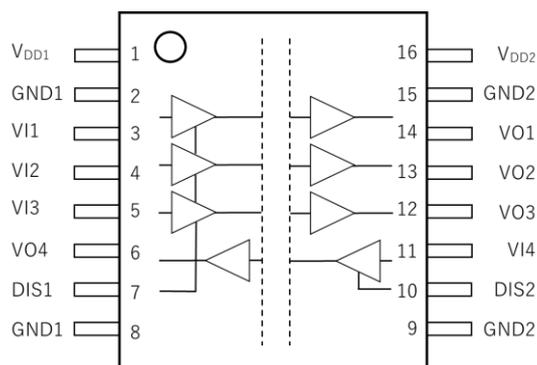
図 6.1 端子配置図 (top view)
