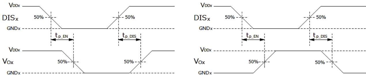
図 8.2 ディセーブル伝搬遅延時間 波形図
