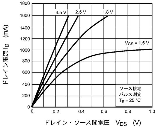
図 7.1  $I_D - V_{DS}$
