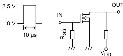
図 5.3.1 スwitchング時間の測定回路
