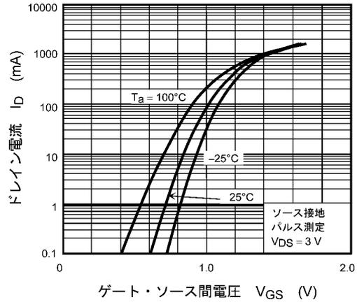
図 7.2  $I_D - V_{GS}$
