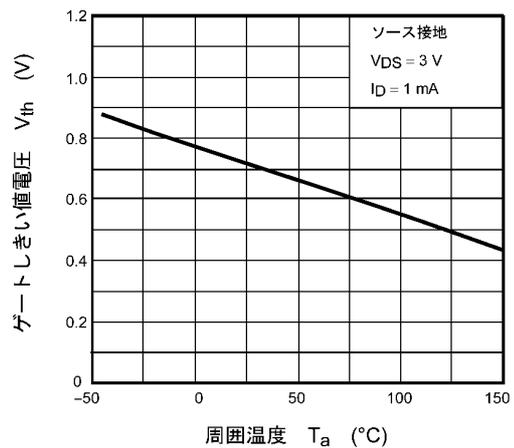
図 7.6  $V_{th} - T_a$
