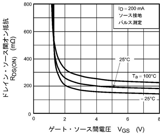
図 7.3  $R_{DS(ON)} - V_{GS}$
