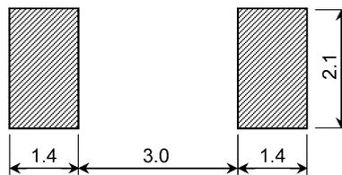
図 8.1 参考パッド寸法 (Unit: mm)
