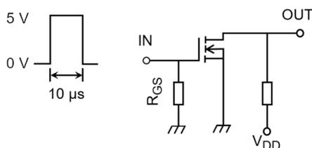
図 5.3.1 スwitching時間の測定回路
