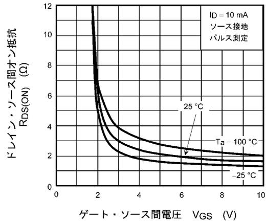
図 7.4  $R_{DS(ON)} - V_{GS}$
