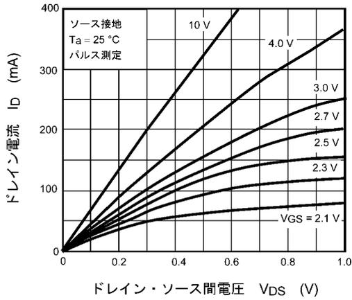
図 7.1  $I_D - V_{DS}$
