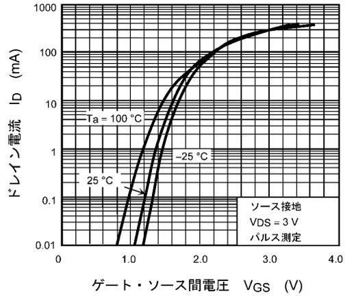
図 7.2  $I_D - V_{GS}$
