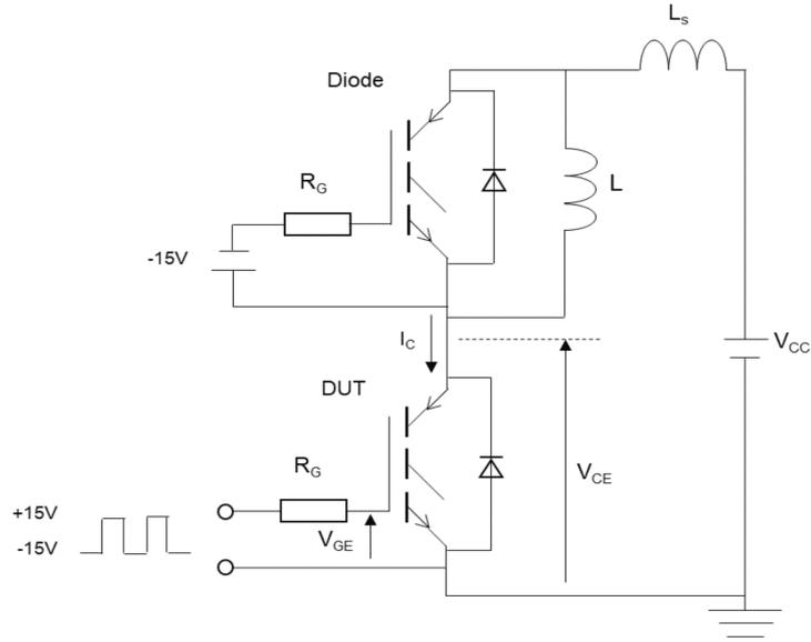
図 6.1 測定回路(トランジスター部)
