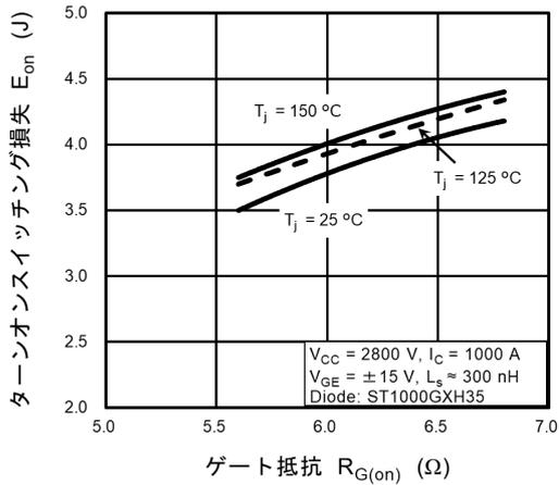
図 7.7  $E_{on} - R_{G(on)}$
