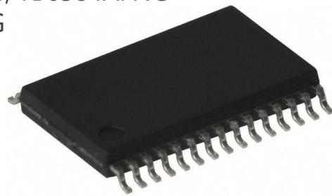
SSOP30-P-300-0.65 Package (10.2 x 7.6 x 1.6 mm)
