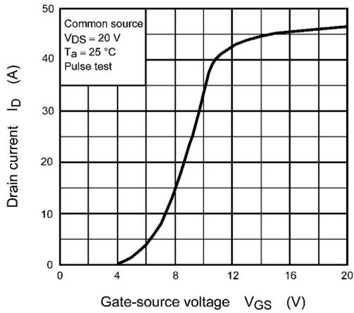
**Fig. 8.3  $I_D - V_{GS}$**
