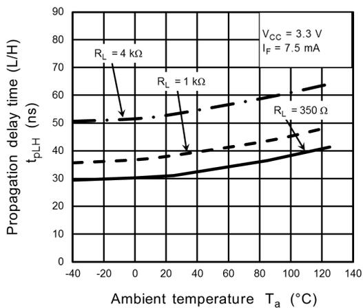
**Fig. 13.2.17**  $t_{pLH} - T_a$
