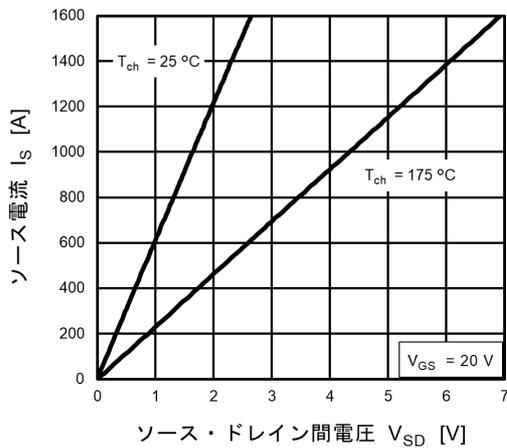
図 8.3  $I_S - V_{SD}$  (注1)
