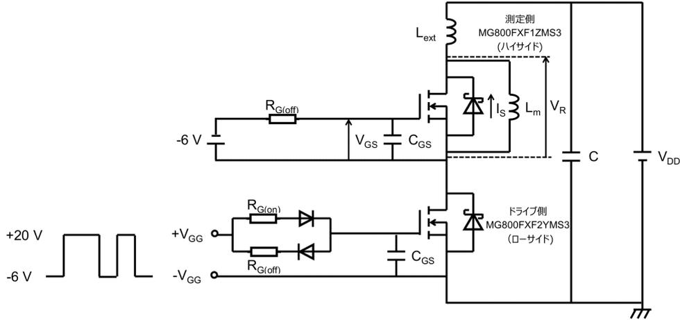
図 7.3 逆回復特性測定回路 (MOSFET部)
