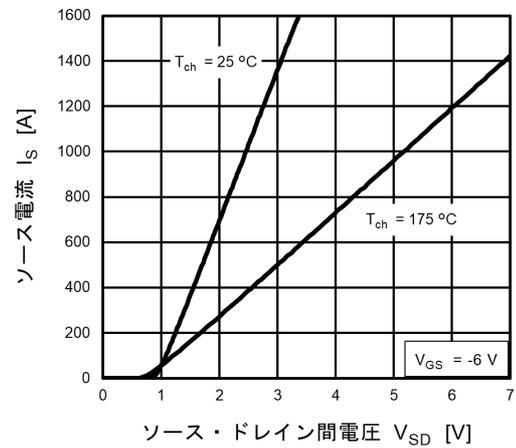
図 8.4  $I_S - V_{SD}$  (注1)
