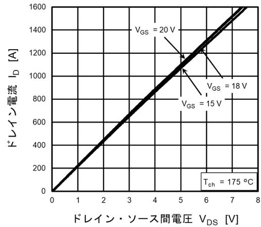
図 8.2  $I_D - V_{DS}$  (注1)
