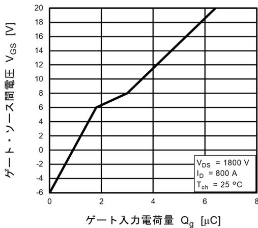
図 8.5  $V_{GS} - Q_g$
