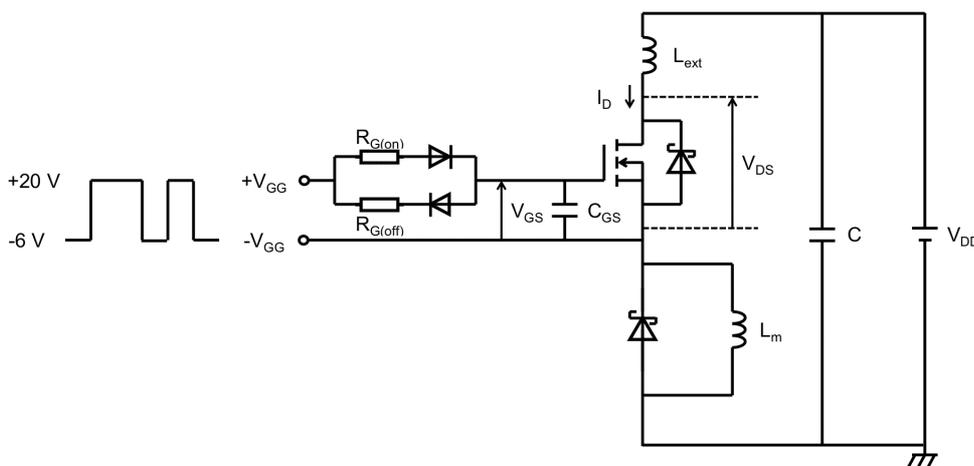
図 7.1 誘導負荷スイッチング測定回路
