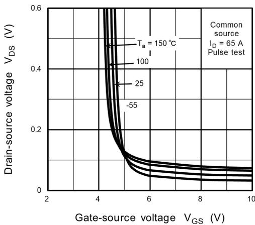
Fig. 8.3  $V_{DS} - V_{GS}$
