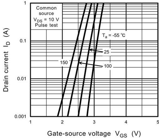
**Fig. 8.7  $I_D - V_{GS}$**
