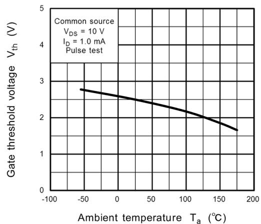
**Fig. 8.12  $V_{th} - T_a$**
