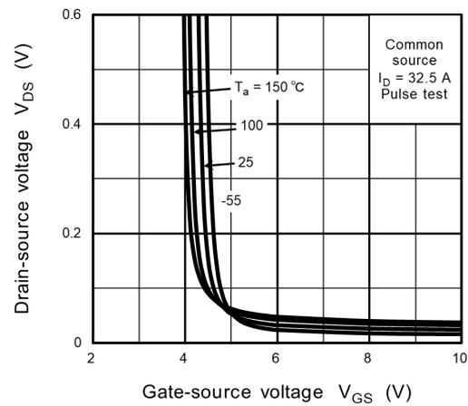
Fig. 8.4  $V_{DS} - V_{GS}$
