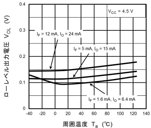
図 12.2.6  $V_{OL} - T_a$
