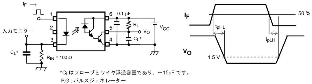
図 12.1.1 伝搬遅延時間測定回路, 波形
