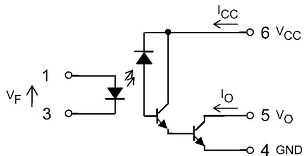
注: 6ピンと4ピンの間にバイパス用のコンデンサー0.1  $\mu$ Fを付ける必要があります。
