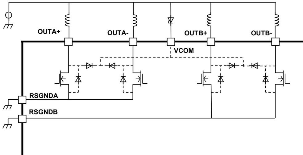
図 6.1 BRAKE モード等価回路
