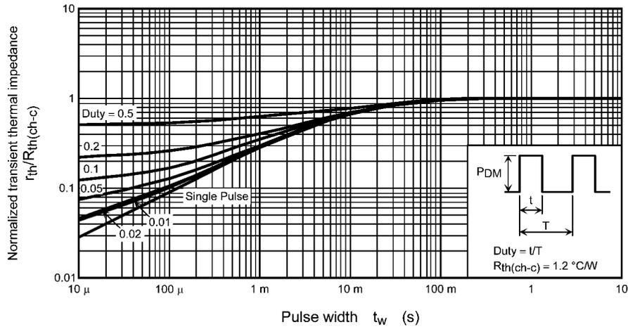
**Fig. 8.12**  $r_{th}/R_{th}(ch-c) - t_w$
