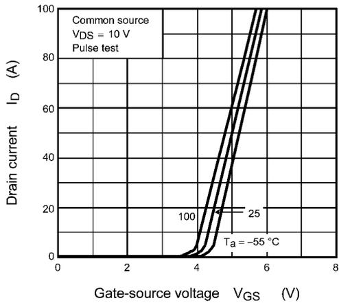
Fig. 8.3  $I_D - V_{GS}$
