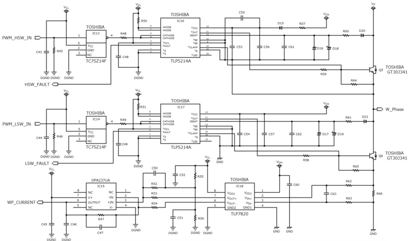
(d) W-phase diagram for inverter circuit 1
