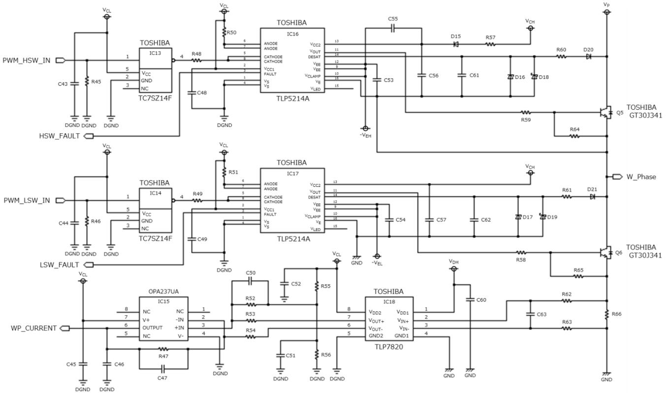
(d) W-phase diagram for inverter circuit 2
