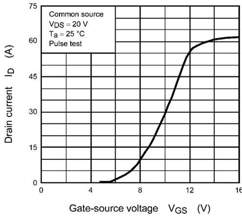
**Fig. 8.3  $I_D - V_{GS}$**
