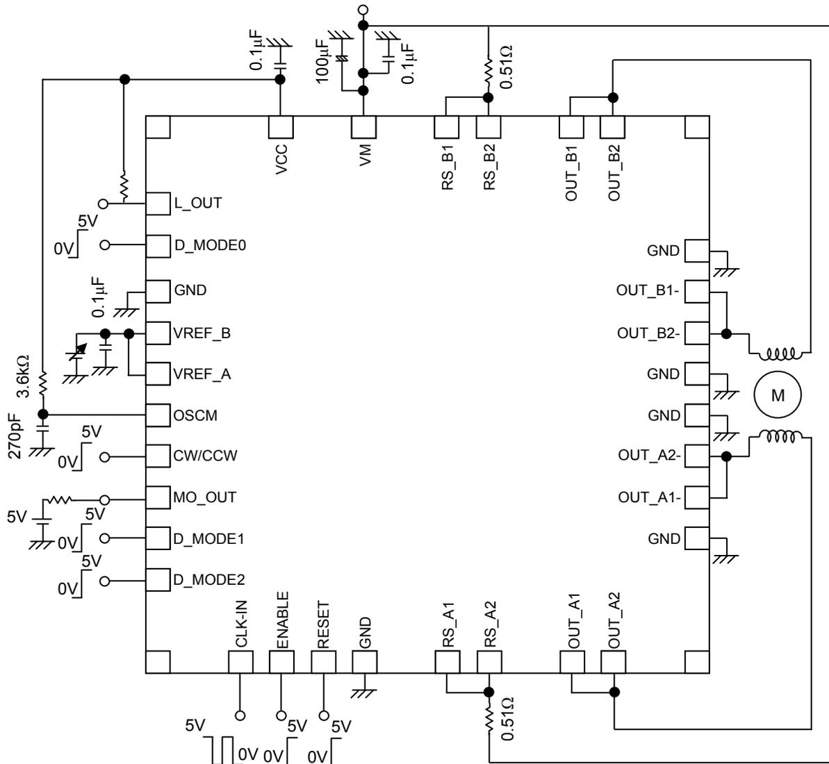
注：必要に応じて、バイパスコンデンサの追加を推奨致します。GND 配線は、できる限り 1 点接地になるようお願い致します。
