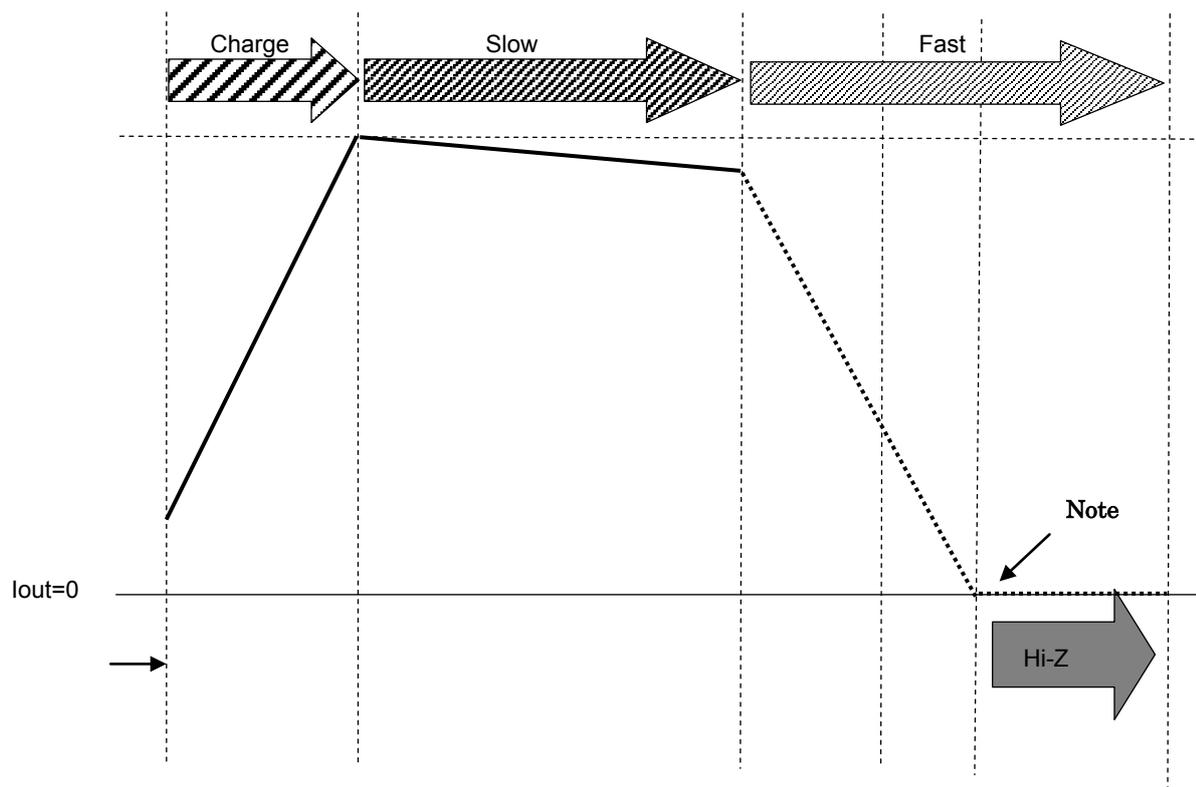
注: 零点( $I_{out}=0A$ )に到達した場合に出力を Hi-Z とします。
