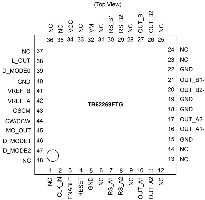
※QFN パッケージのコーナーPAD および裏面放熱 PAD は必ず基板の GND に接続頂きますようお願い致します。
