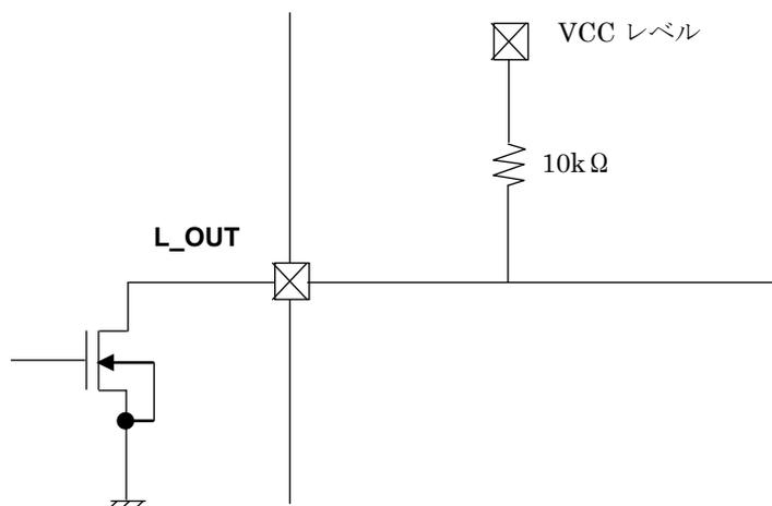
LO 端子はオープンドレイン出力です。出力端子を抵抗で 3.3V/5V 電源に Pull Up した場合、TSD/ISD を検出した場合には Low(内部 MOSFET=ON)、通常動作時(TSD/ISD 未検出時)は、High(内部 MOSFET=OFF)が出力されます。
