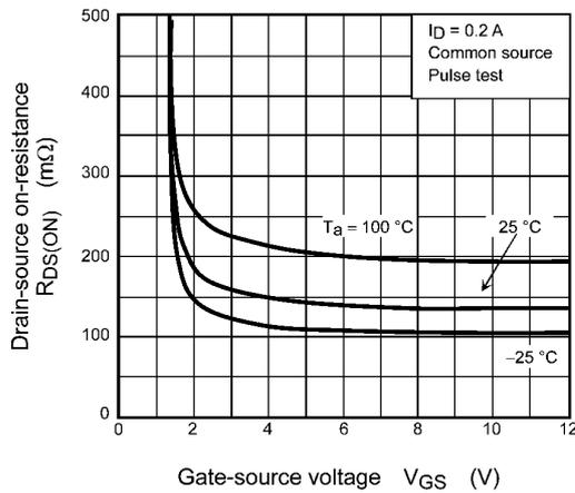
**Fig. 7.1.3**  $R_{DS(ON)} - V_{GS}$
