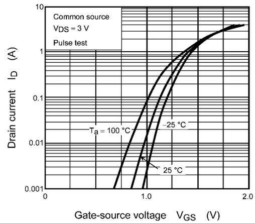
**Fig. 7.1.2**  $I_D - V_{GS}$
