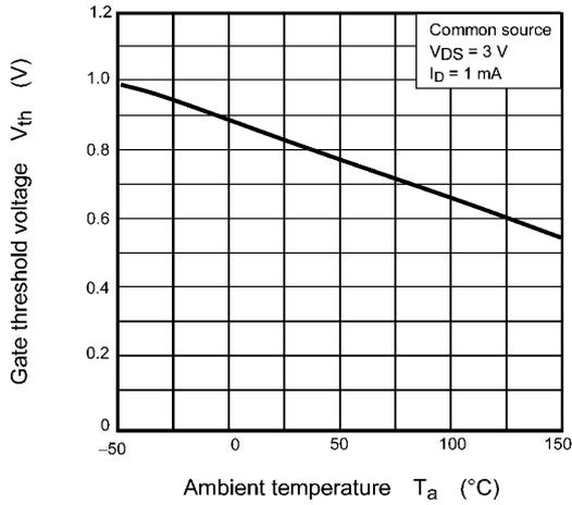
**Fig. 7.1.7  $V_{th} - T_a$**
