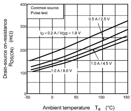
**Fig. 7.1.6**  $R_{DS(ON)} - T_a$
