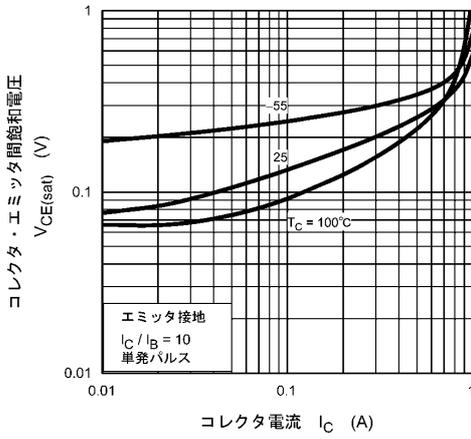
図 7.3  $V_{CE(sat)} - I_C$
