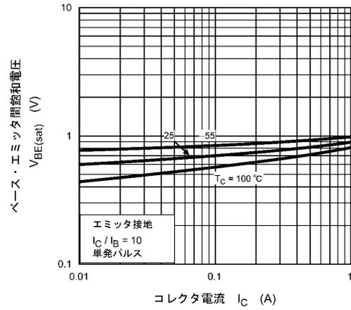
図 7.4  $V_{BE(sat)} - I_C$
