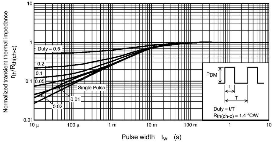
**Fig. 8.12**  $r_{th}/R_{th}(ch-c) - t_w$
