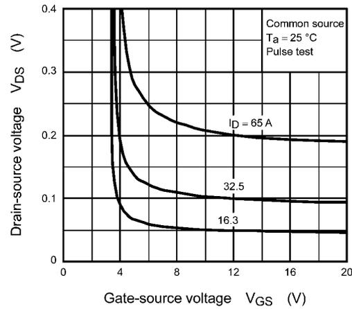
Fig. 8.4  $V_{DS} - V_{GS}$
