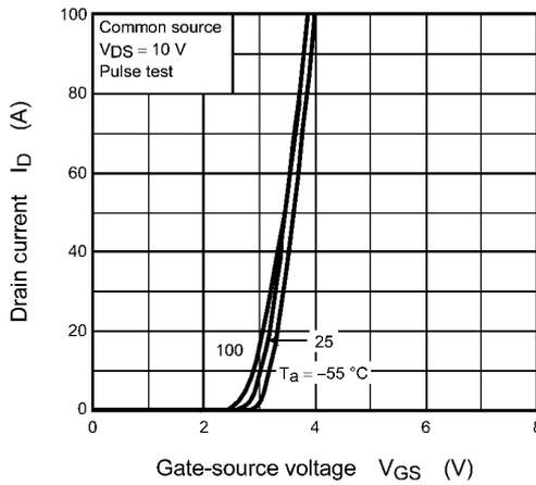
Fig. 8.3  $I_D - V_{GS}$
