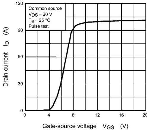
**Fig. 8.3  $I_D - V_{GS}$**
