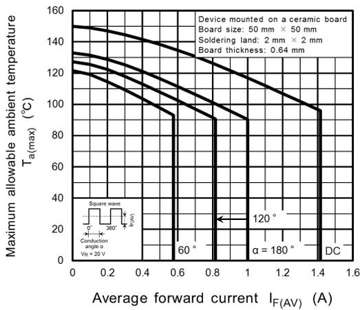
**Fig. 10.3  $T_{a(max)} - I_{F(AV)}$**
