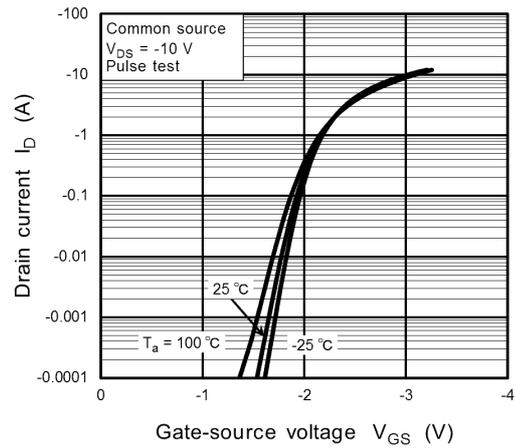
Fig. 7.2  $I_D - V_{GS}$
