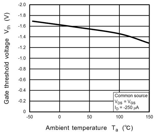
Fig. 7.6  $V_{th} - T_a$
