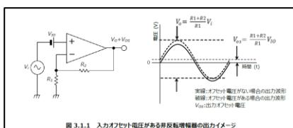
図 3.1.1 入カオフセット電圧がある非反転増幅器の出力イメージ
