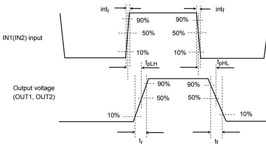
注:IN1 端子 (IN2 端子) に信号を入力するとき、入カスイッチングノイズで誤動作しないように IN1 端子 (IN2 端子) と GND 間にコンデンサを接続するなどして  $int_r$ ,  $int_f$  は 10ns 以上設けることを推奨します。
