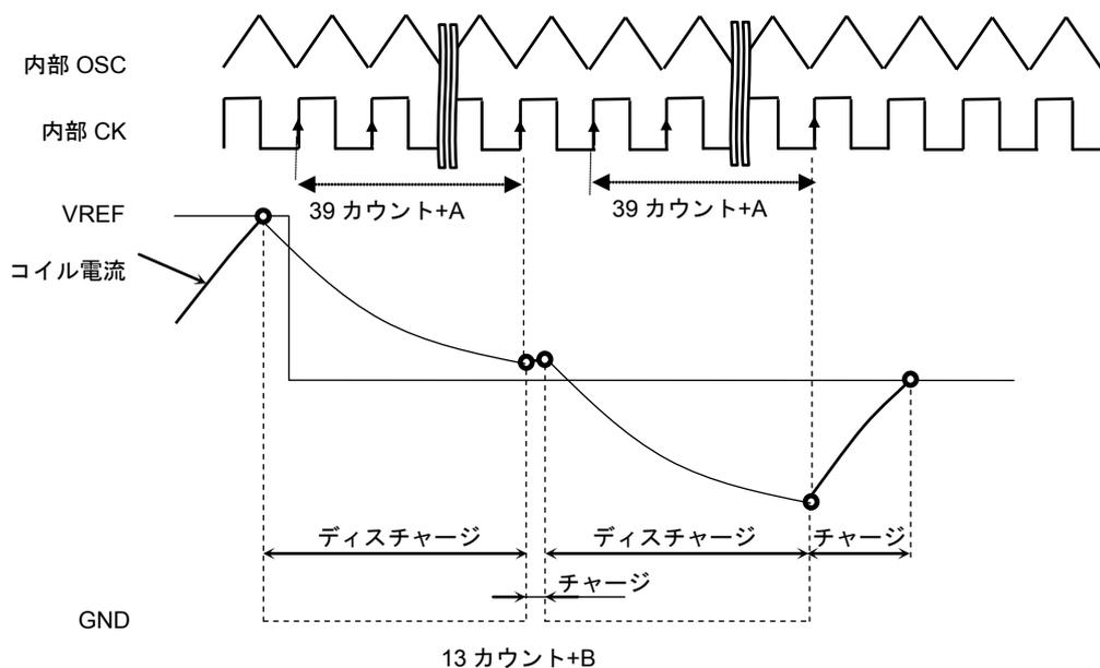
(5) 設定電流切り替わり時動作 (加速時)
