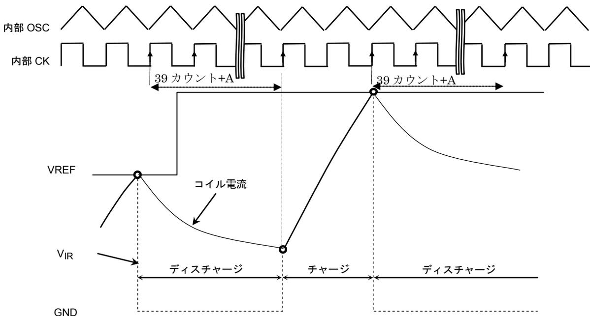
ピーク電流検出方式により、定電流動作による平均電流値は設定電流値に対し低くなります。モータコイル特性により変わりますので、設定の際には十分確認ください。
