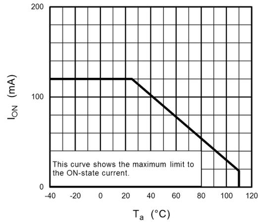
Fig. 14.2 I<sub>ON</sub> - T<sub>a</sub>
