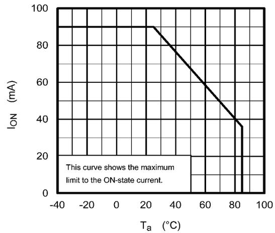
Fig. 16.2 I<sub>ON</sub> - T<sub>a</sub>
