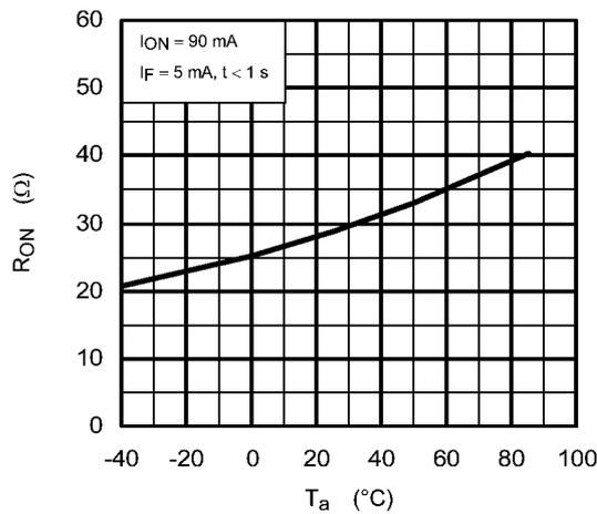
Fig. 16.5 R<sub>ON</sub> - T<sub>a</sub>
