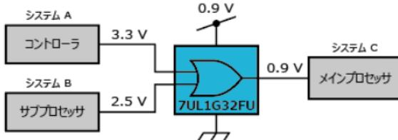
低電圧動作特性や、低い入力しきい値を持つ特性の応用でレベル変換+論理変換を実現します。
