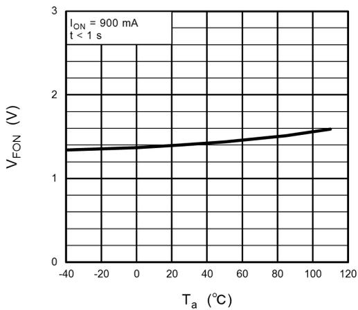
図 12.5  $V_{FON} - T_a$
