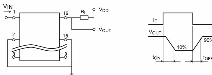
図 11.1 スイッチング時間測定回路, 波形
