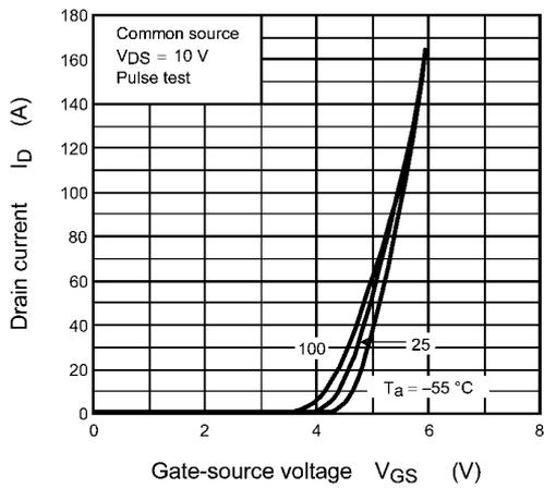
**Fig. 8.3**  $I_D - V_{GS}$
