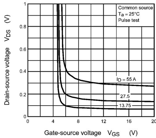
**Fig. 8.4**  $V_{DS} - V_{GS}$
