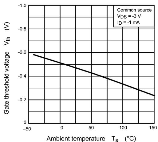
Fig. 7.6  $V_{th} - T_a$
