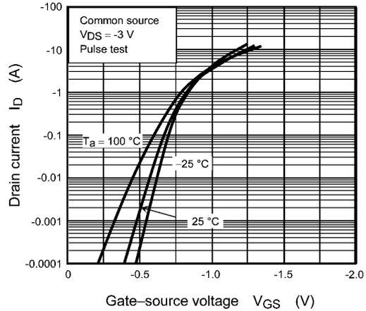
Fig. 7.2  $I_D - V_{GS}$
