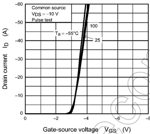
Fig. 8.3  $I_D - V_{GS}$
