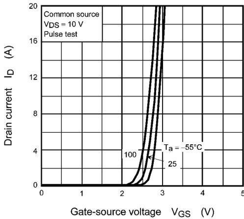
Fig. 8.3  $I_D - V_{GS}$
