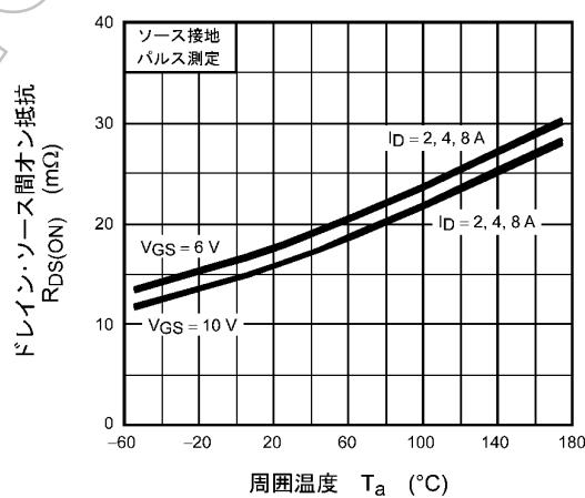
図 8.6  $R_{DS(ON)} - T_a$  (注7)
