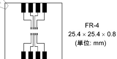
図 5.2 ガラスエポキシ基板 実装例b
