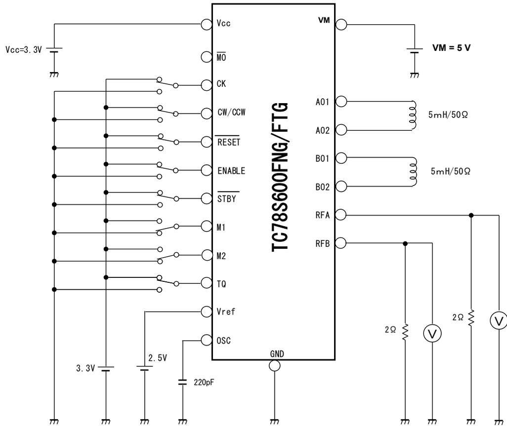
**Test circuit 4:**  $V_{SAT(UL)}$
