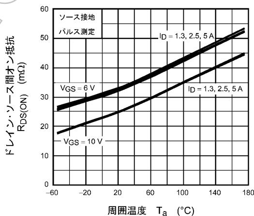
図 8.6  $R_{DS(\text{ON})} - T_a$  (注7)
