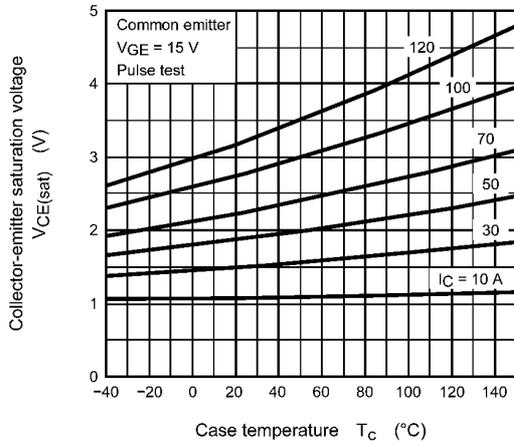
Fig. 8.9  $V_{CE(sat)} - T_c$
