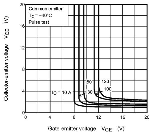
**Fig. 8.6  $V_{CE} - V_{GE}$**
