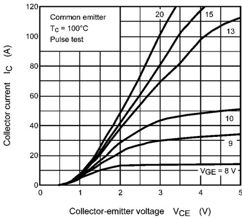
**Fig. 8.3  $I_C - V_{CE}$**
