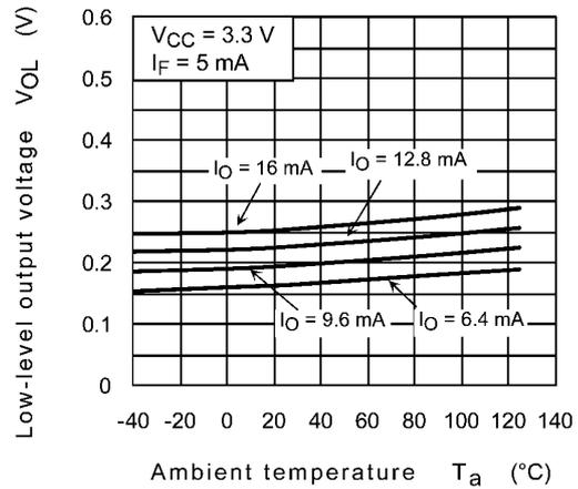
**Fig. 12.2.4  $V_{OL} - T_a$**
