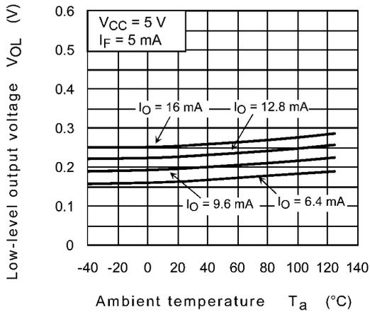
**Fig. 12.2.3  $V_{OL} - T_a$**
