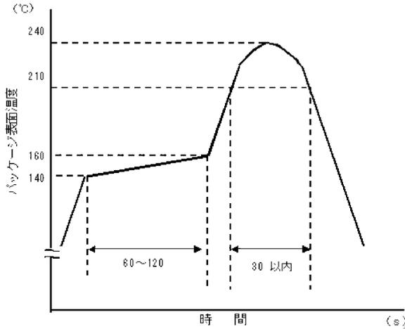
図 13.1.1 共晶はんだ使用時の温度
