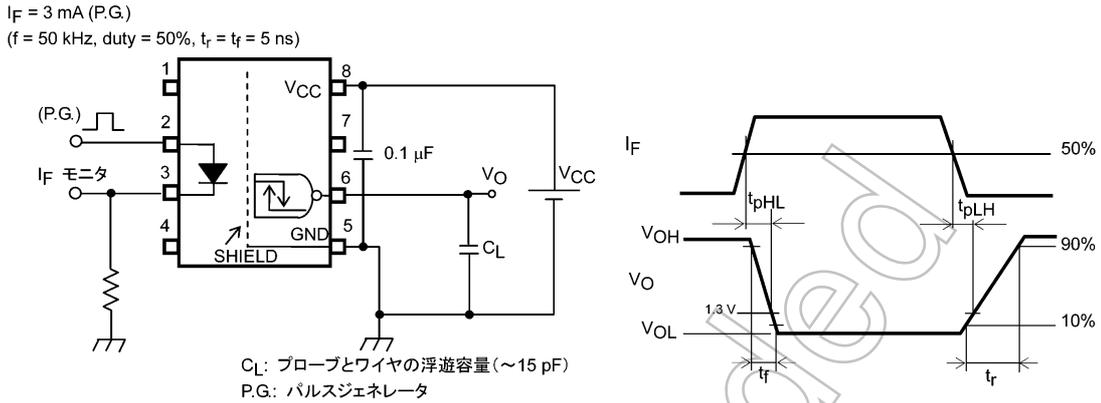
図 12.1.8 伝搬遅延時間測定回路, 波形
