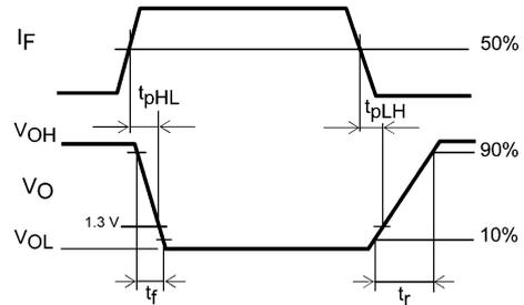
図 12.1.7 伝搬遅延時間測定回路, 波形
