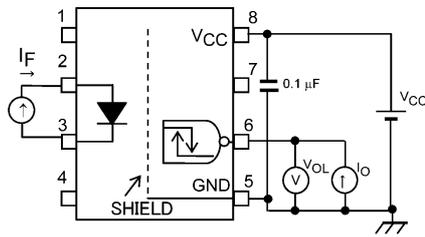
図 12.1.1 VOL測定回路
