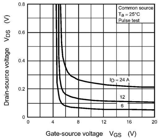
Fig. 8.4  $V_{DS} - V_{GS}$
