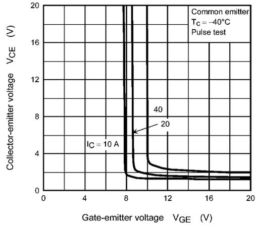
**Fig. 8.2  $V_{CE} - V_{GE}$**
