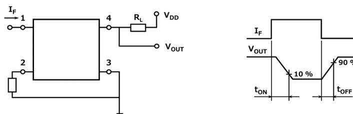
図 11.1 スイッチング時間測定回路, 波形
