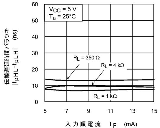
図 12.2.16  $|t_{pHL} - t_{pLH}| - I_F$
