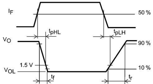
図 12.1.5 伝搬遅延時間測定回路, 波形
