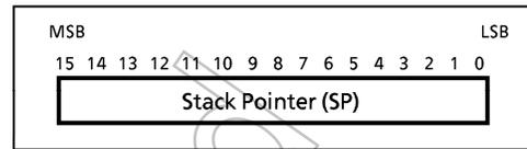
Figure 1-7. Stack Pointer
