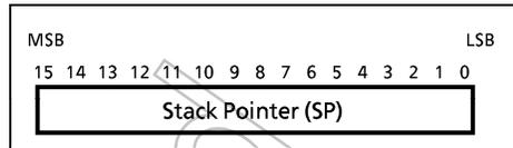
Figure 1-7. Stack Pointer
