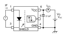
図 4 ICCH 測定回路
