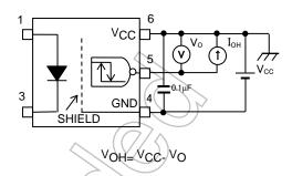
図 3 ICCL 測定回路
